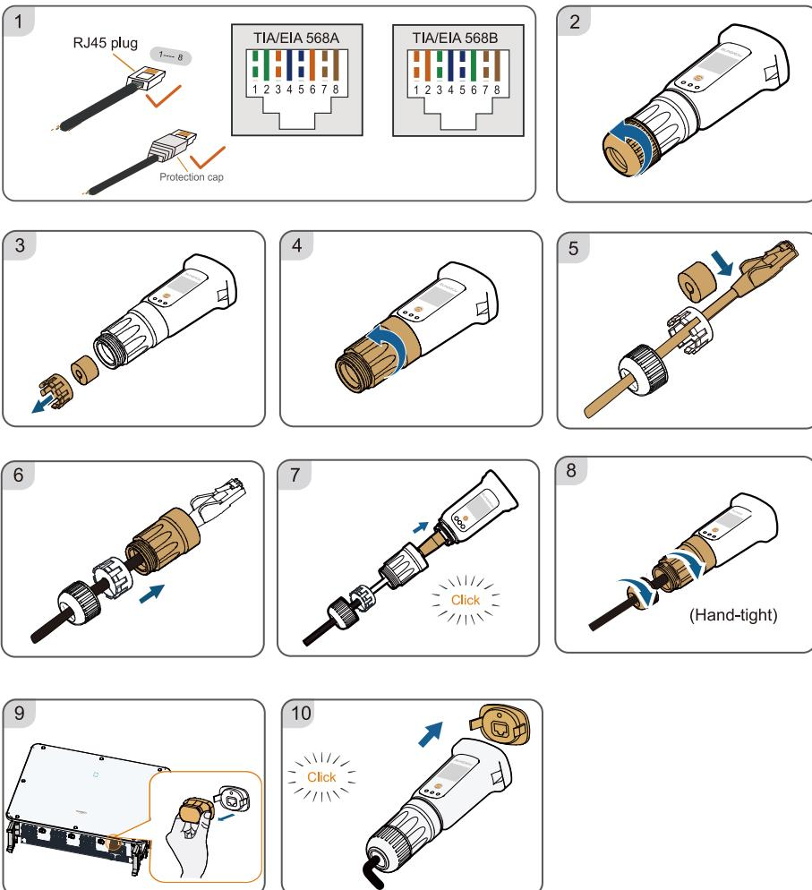
RS485 Communication Connection / Caja de conexiones de comunicación RS485 / RS485 آلات اتصال اتصال / Anschluss RS485
