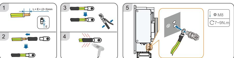
AC Connection (For a multi-core cable) / Conexión de CA (para cables de varios núcleos) / Anschluss
